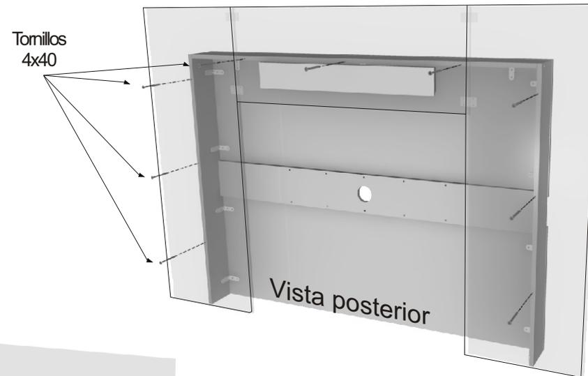
**PASO 5:** Amurar la faja de anclaje a pared mediante ramplus y tornillos (no incluidos).
