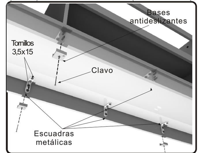
**PASO 6:** Antes de clavar los fondos para rigidizar la estructura, chequear que la estructura este perfectamente escuadrada.
