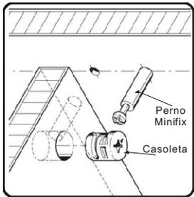
**PASO 5 :** Unir techo a parantes y costados mediante tornillo minifix y casoleta. Atornillar pernos minifix en el techo, luego colocar casoletas en los orificios de mayor diámetro en los costados y parantes, teniendo en cuenta de alinear la flecha indicadora con el perno minifix. Introducir el perno minifix en la casoleta. Luego ajustar con destornillador la casoleta hasta lograr un perfecto y firme ensamblaje. Por ultimo colocar a presión los soportes de estante metálicos.
