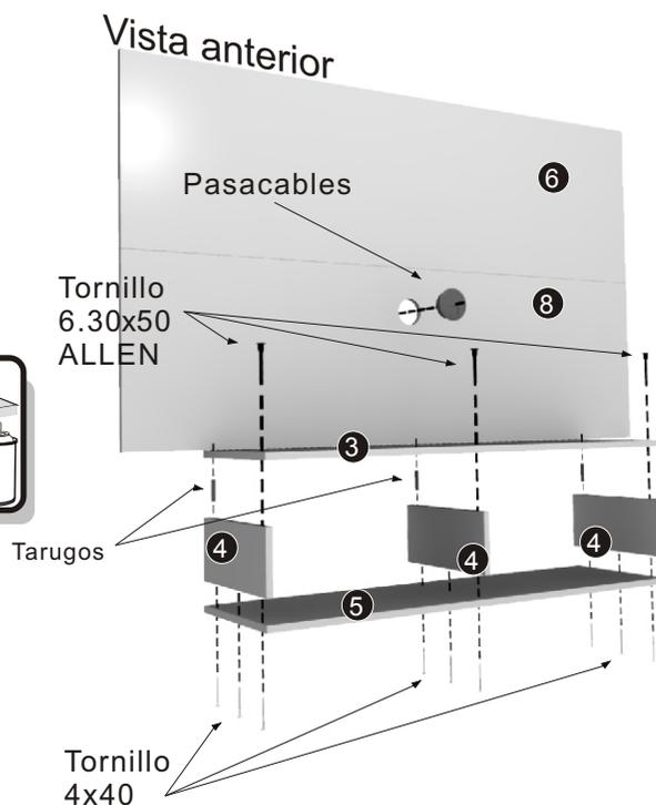
**PASO 4:** Colocar Faja Anclaje y fijarla mediante casquillos y tornillos de unión de paneles y Arandela luego colocar paneles inferiores cortos y fijarlos a la estructura ya armada mediante los tornillos detallados En la imagen.
