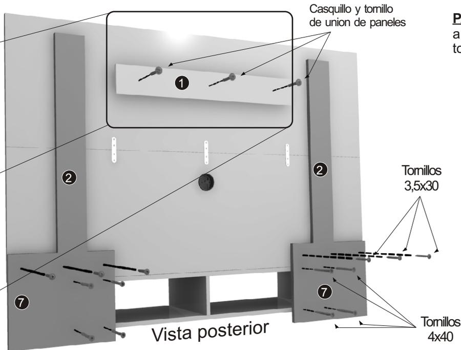
**PASO 5:** Amurar Faja Anclaje a la pared mediante ramplus y tornillos (no incluidos).
