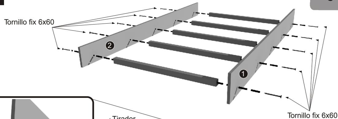
**PASO 1:** Atornillar travesaños a frente y contrafrente de carro mediante tornillo Fix 6x60.
