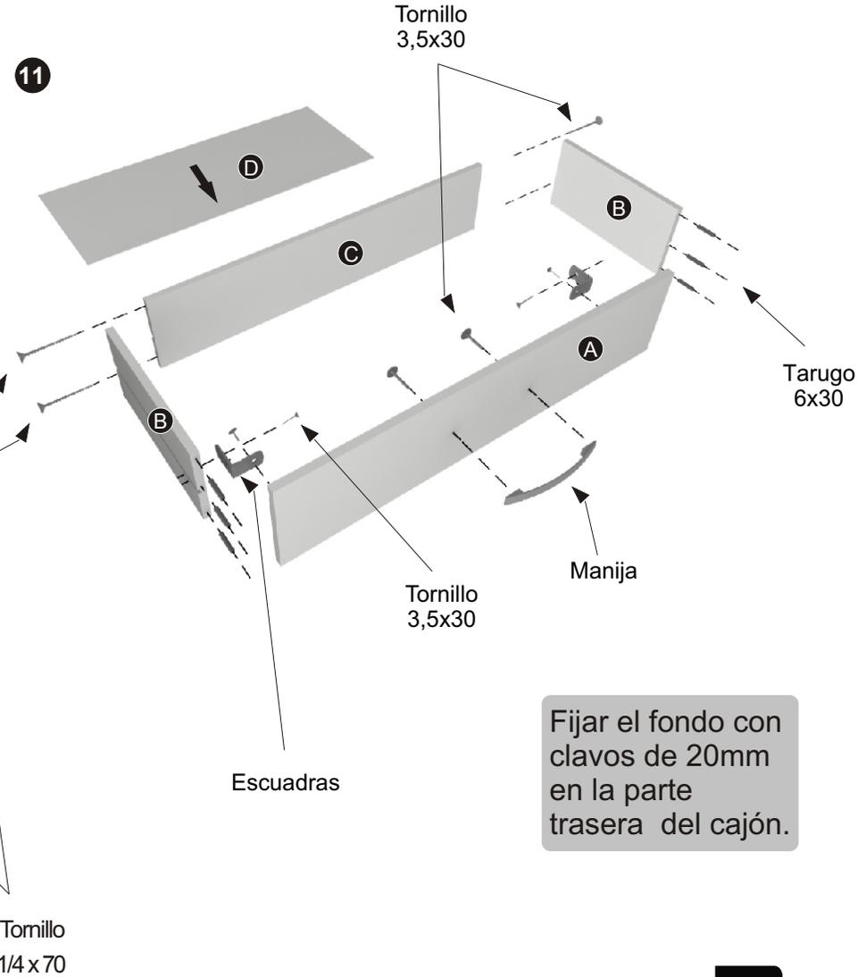
Fijar el fondo con clavos de 20mm en la parte trasera del cajón.
