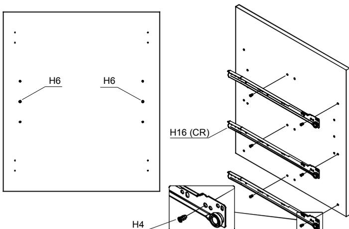
Colocar en el Parante (P4), como muestra la figura, 3 Guías metálicas (H16 - CL) (Buscar la sigla "CL" en la guía). Estas deben ser fijadas con Tornillos 6x10 (H4)
